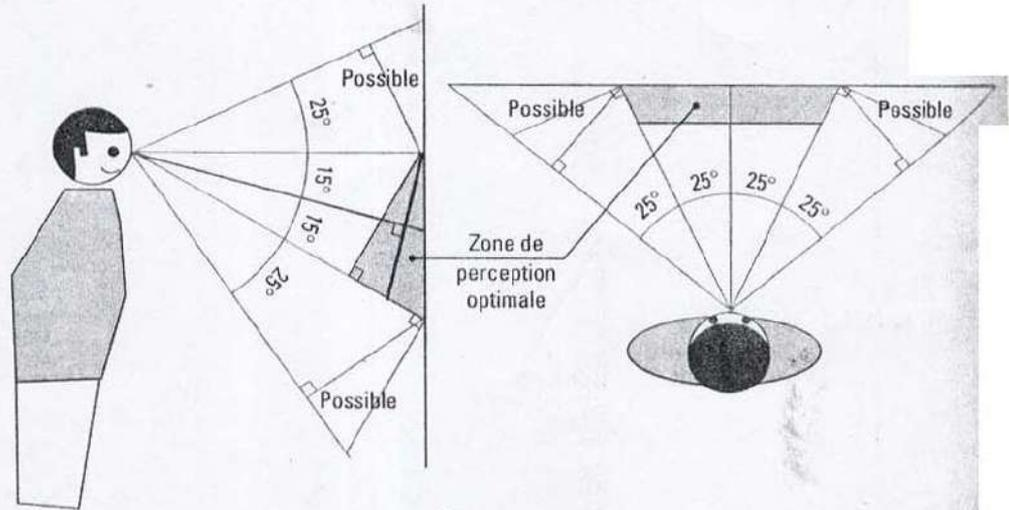
Sur une machine-outil, la plupart des signaux reçus par l'opérateur sont visuels. Ils doivent être placés dans le champ de vision de l'opérateur.
