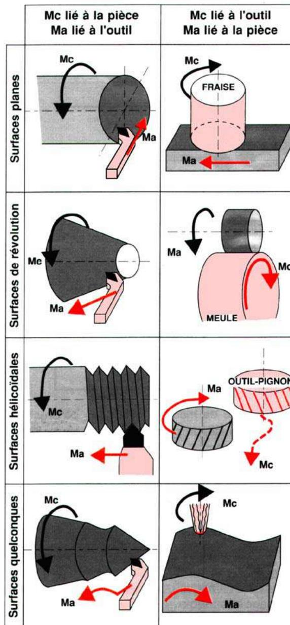
Il est possible d'associer d'autres mouvements et de définir d'autres principes d'usinage comme le perçage par exemple ou les deux mouvements  $M_c$  et  $M_a$  sont liés à l'outil.
