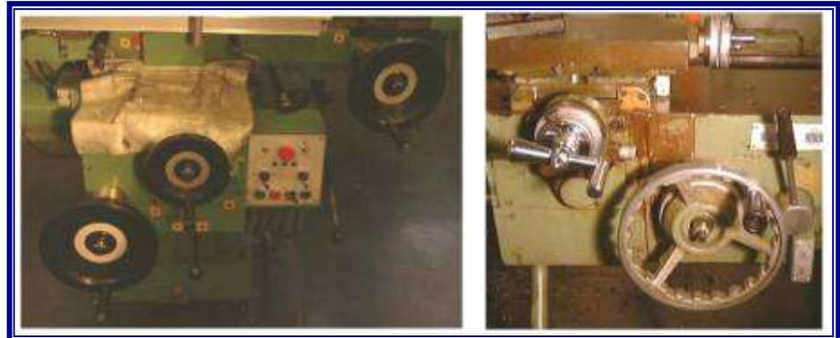
Des moteurs permettent aussi de choisir des vitesses d'avance suivant les axes de déplacements. Le choix de ces vitesses s'effectue par l'intermédiaire d'une boîte de vitesse mécanique.
