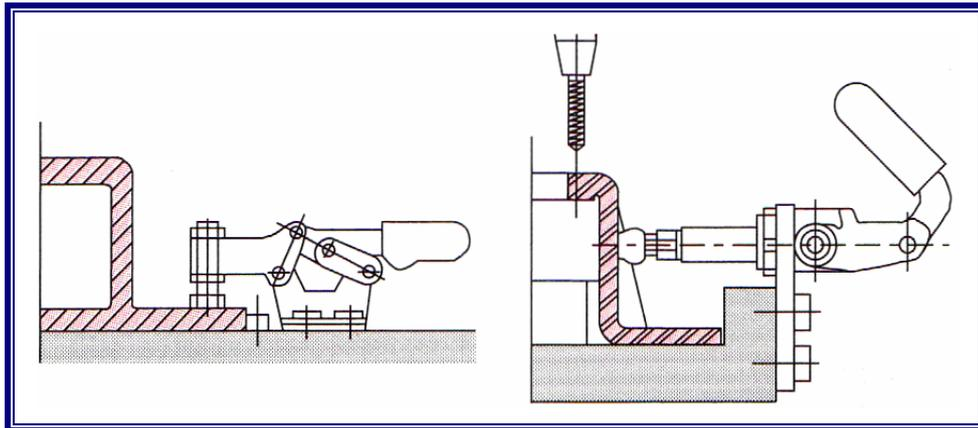
Figure 4. Sauterelles à levier horizontal et sauterelles à pousser
