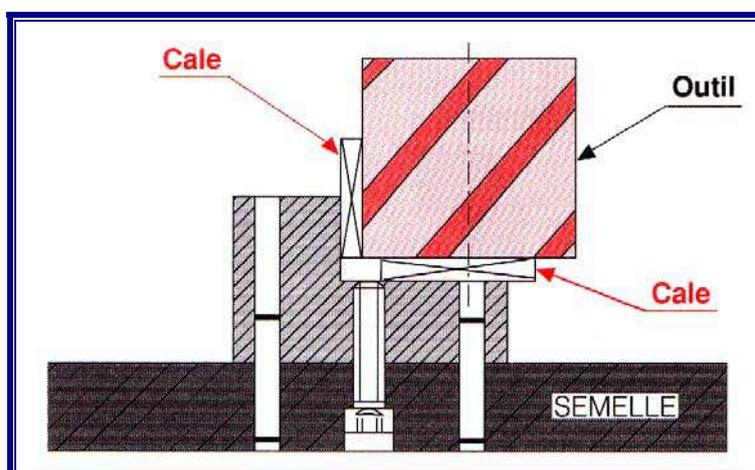
Figure 8. Dispositif de réglage de l'outil
