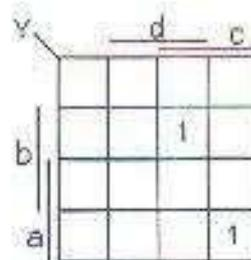
Dans l'exemple 2 nous lisons que Y est égale à a ET b ET c ET d OU a ET b ET c ET d et nous écrivons  $Y = a . b . c . d + a . b . c . d$
