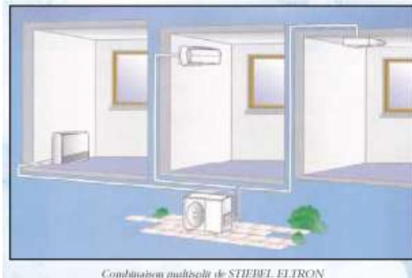
*Il peut être équipé d'une régulation électronique permettant d'afficher la température à maintenir pilotée par fil ou télécommande à infrarouge. Ce matériel présente plusieurs atouts : il est silencieux, les puissances proposées sont plus importantes, mais amènent des désagréments d'ordre esthétique, avec les raccordements apparents à l'unité extérieure.*
