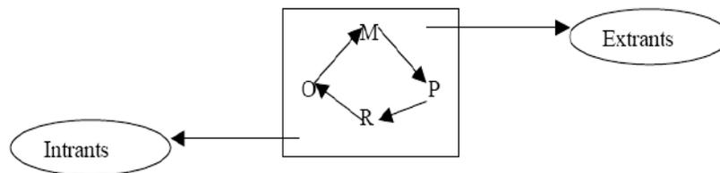
R : module de régulation O : module opératoire M : module de mesure P : module de pilotage
