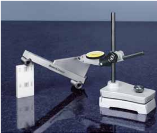
c) Contrôle d'inclinaison avec comparateur
