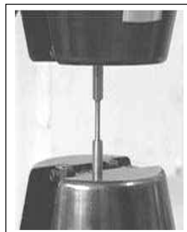
Éprouvette installée entre les mors de machine de traction
