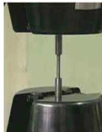
3. Epreuve installée entre les mors de machine de traction.
