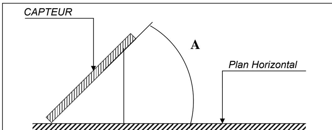
L'inclinaison doit être choisie en fonction du moment d'utilisation de l'installation, l'inclinaison du soleil changeant suivant les saisons.
