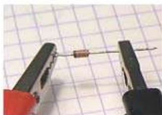
Fil rouge coté bague et fil noir à l'autre passe: le courant passe
