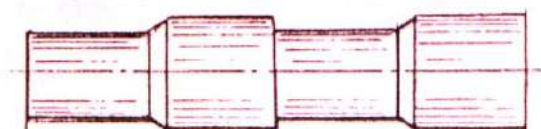
Figure2-7 Façonnage des emboîtements
