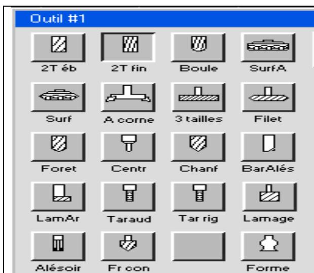
**Type d'outil :** Les boutons de ce secteur s'utilisent pour choisir le type d'outil. Les images et les informations nécessaires pour le diagramme d'outil varient en fonction du type d'outil sélectionné. Pour sélectionner un outil, cliquez sur le bouton de type d'outil correspondant.
