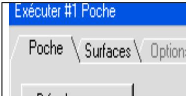
**Type de processus :** Ces boutons déterminent si le processus va générer une opération d'ébauche ou de surfacage. La sélection par défaut est l'ébauche. Lorsque **Surfacage** est sélectionné, la partie inférieure de la fenêtre change. Les informations relatives aux cycles de surfacage sont décrites à la suite de l'ébauche.
