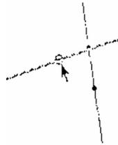
De manière à créer des terminateurs, un point et un élément qui se coupent doivent être sélectionnés.
