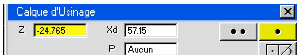
La case P de la fenêtre de géométrie Point affiche un label lorsqu'un point est sélectionné avec la touche appropriée de modification enclenchée (Alt, Commande, Contrôle, cela dépend de la plate-forme). Les coordonnées du point sont également montrées. Si le curseur est dans la case des Z, seule la coordonnée Z est donnée. Si le curseur est dans la case des dX, seule la coordonnée dX est donnée. Si le curseur est dans la case P, les deux coordonnées sont données.
