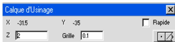
Cette fenêtre est unique en ce sens qu'elle permet de créer une géométrie en rapide. Elle est particulièrement utile pour se déplacer rationnellement autour de la pièce en évitant toute collision.
