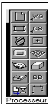
Une fois que les opérations d'usinage de la pièce ont été créées, le fichier doit être postprocessé. **Postprocesser** convertit un fichier (fichier. VNC) contenant les opérations d'usinage (parcours d'outil) en un fichier texte (programme CNC) pouvant être transféré dans la commande numérique. Des postprocesseurs spécifiques à chaque commande sont utilisés pour convertir les fichier.VNC en fichier texte.
