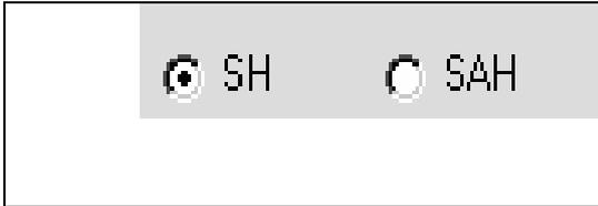
**Sens de rotation de la broche :** Les boutons SH (sens horaire) et SAH (sens anti-horaire) sont utilisés pour donner le sens de rotation de la broche pour l'outil sélectionné.
