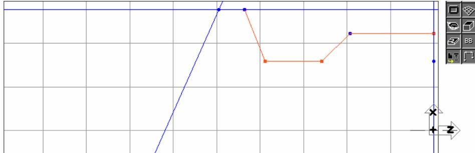
Maintenant, nous allons connecter les lignes avec le point à  $Z=-63.5$ ,  $dX=71.12$
