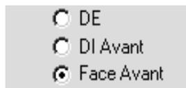
Pour positionner l'outil qui va usiner la face de notre pièce, il est nécessaire d'avoir une approche et un dégagement en Z. C'est pour cela que nous choisirons **Face avant**. Il est très important de déplacer et positionner l'outil de manière correcte.
