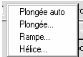
**Type de plongée :** Ces boutons permettent de définir comment l'outil plonge dans la matière. Si l'option **Plongée auto** est sélectionnée, le système détermine la meilleure position pour la plongée de l'outil dans la matière sur la base du parcours créé par l'opération. Les autres options appellent des fenêtres permettant à l'utilisateur de spécifier le mode de plongée dans l'outil.
