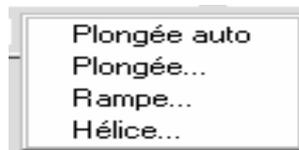
Les sélections de méthode d'entrée de l'outil déterminent comment l'outil pénètre dans la matière. Lorsque **Plongée auto** est sélectionnée, le système calcule la position optimale de plongée de l'outil dans la matière, avant la coupe.
