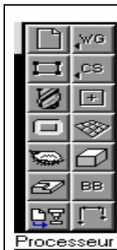
Une fois que les opérations d'usinage de la pièce ont été créées, le fichier doit être postprocessé. **Post processor** convertit un fichier (fichier. VNC) contenant les opérations d'usinage (parcours d'outil) en un fichier texte (programme CNC) pouvant être transféré dans la commande numérique. Des postprocesseurs spécifiques à chaque commande sont utilisés pour convertir les fichier.VNC en fichier texte.
