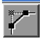
Le bouton **Congé- Chanfrein** ne peut être utilisé que si un, ou des points, sont sélectionnés. De plus, si les points sélectionnés ne sont pas des connecteurs, la sélection pour un **Congé- Chanfrein** n'aura pas des effets.
