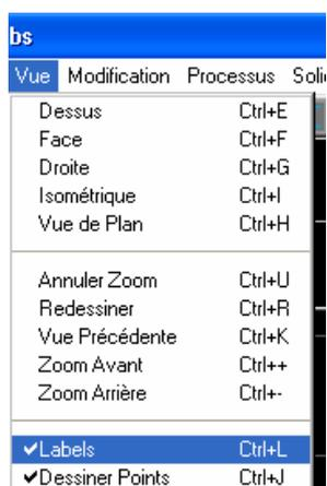
Toutes les géométries créées seront définies par une lettre indiquant le type de géométrie, P- point, C- Cercle, L- ligne, et un autre chiffre indiquant l'ordre de construction.
